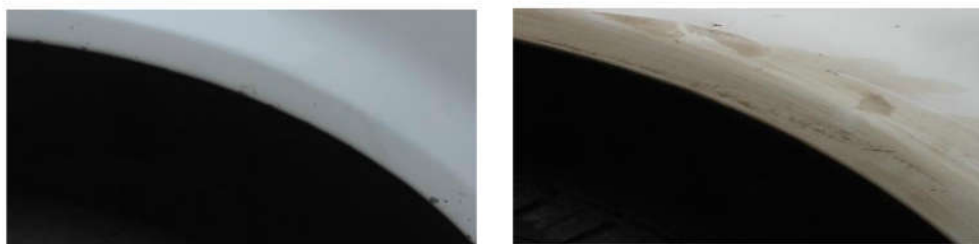
Рис. 1. Вид переднего левого крыла автомобиля: а – следы контакта с другим автомобилем невидимы; б – следы контакта с другим автомобилем, выявленные с помощью магнитного дактилоскопического порошка
